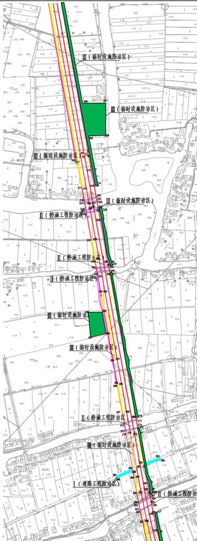
便道、施工工区、表土堆放场使用完毕后，采用推土机及人工配合平整，场地平整覆土后对损坏的耕地进行恢复，实施复耕
