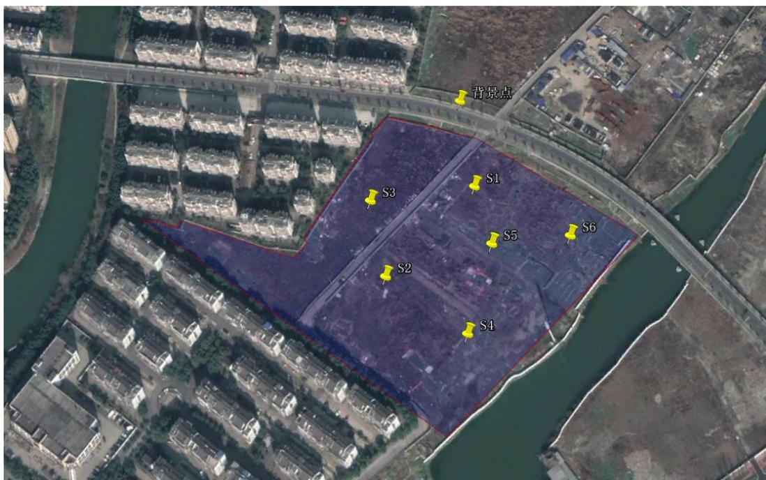
图 4.1-1 初步调查监测方案土壤布点图
