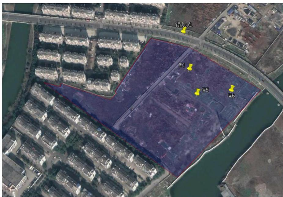
图 4.1-2 初步调查监测方案地下水布点图
